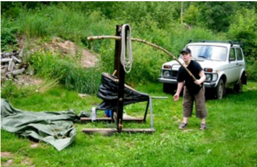
Jussi Jäppinen testaa uusien kaksitoimisten palkeiden puhallustehoa
