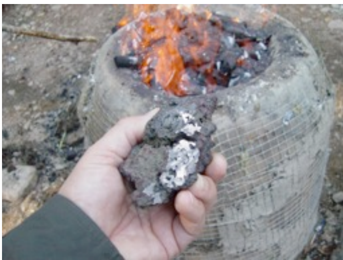
Tekijä ja kanaverkolla tuettu kuilu-uuni toiminnassa. Kädessä ensimmäisessä puhalluksessa syntynyt ja analyyseissa ylihiiliteräkseksi osoittautunut kappale
